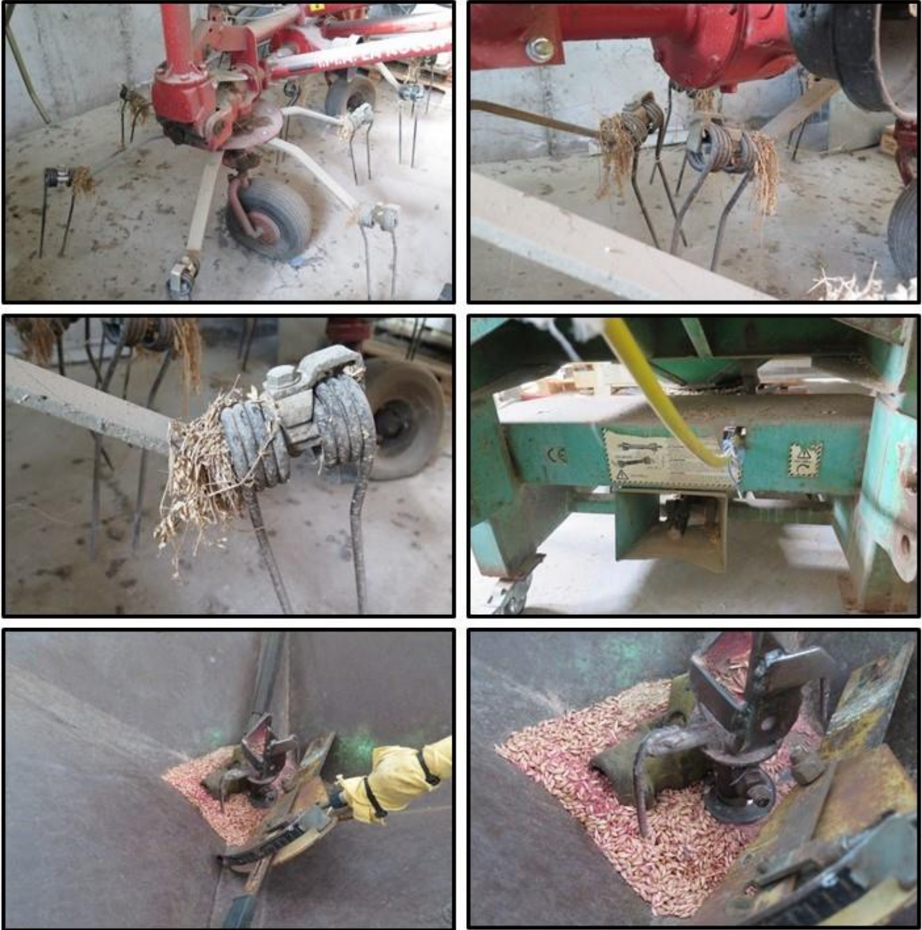
Εικόνα 8. Πλημμελής καθαρισμός του μηχανολογικού εξοπλισμού σε αποθήκη οριζόντιου τύπου του Συνεταιρισμού «ΘΕΣγη» στον οικισμό Καστρί του Νομού Λάρισας.
